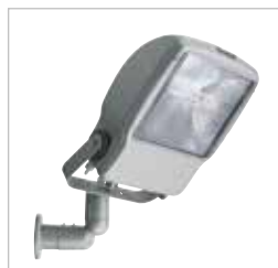
AKRON 3 60238 Per montaggio di un apparecchio singolo a parete costituito da un blocco in lega di alluminio pressofuso, orientabile in senso orizzontale, verniciato in colore Silver.
