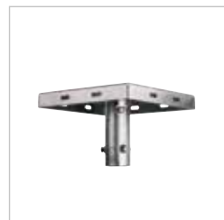
AKRON 4 60242 Accessorio in acciaio zincato a caldo per montaggio n. 4 proiettori pot. max 400W per pali Ø 76 mm max.
