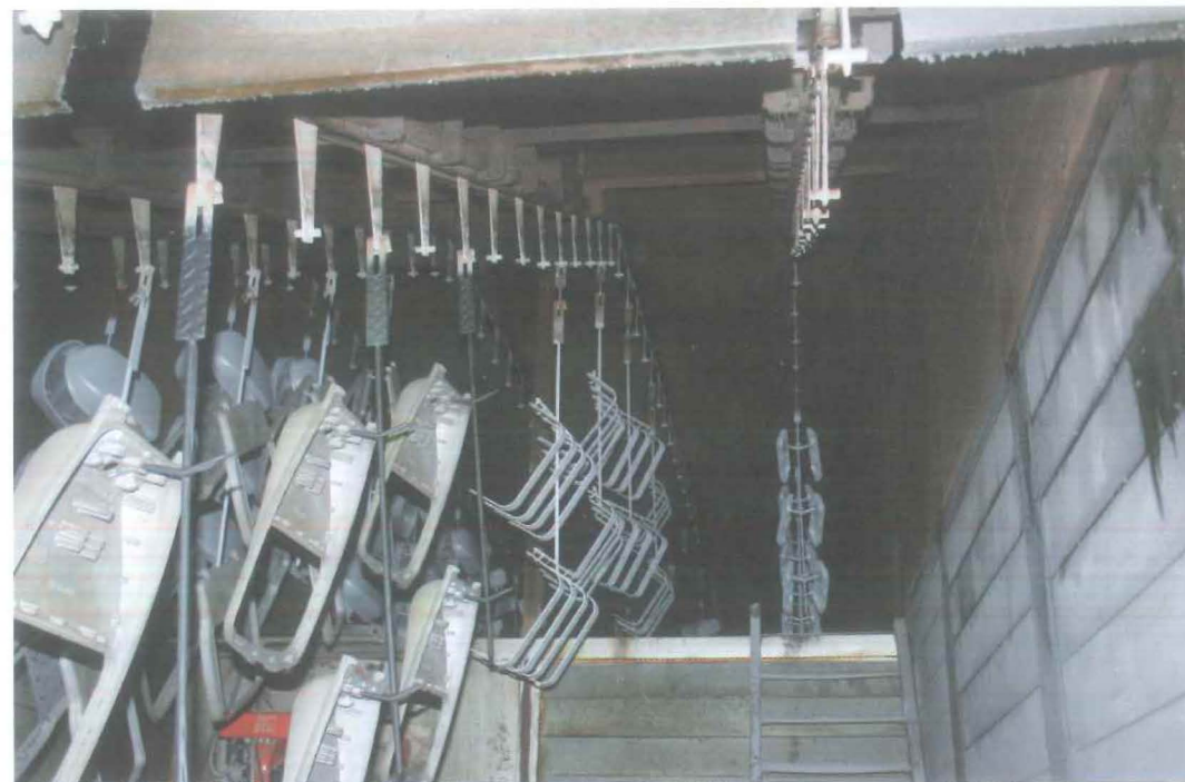
17 - Il forno di cottura polveri ad aria calda, del tipo "a campana". Hot air bell oven
